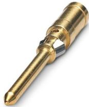
Contatto a crimpare, diametro contatti: 1,6 mm, tornito, Spina, materiale contatti: Lega di rame, superficie contatti: dorato, sezione di connessione: 2,5 mm<sup>2</sup> ... 2,5 mm<sup>2</sup>, AWG 14
