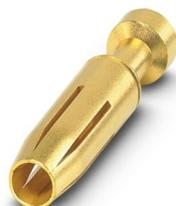
Contatto a crimpare, diametro contatti: 2,5 mm, tornito, Femmina, materiale contatti: Lega di rame, superficie contatti: dorato, sezione di connessione: 4 mm<sup>2</sup> ... 4 mm<sup>2</sup>, AWG 12
