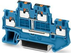
Morsetto a due piani, con ripartitore di potenziale, tensione nominale: 500 V, corrente nominale: 16 A, tipo di connessione: Connessione Push-in, 1. e 2. piano, Sezione di dimensionamento: 1,5 mm<sup>2</sup>, sezione: 0,14 mm<sup>2</sup> - 1,5 mm<sup>2</sup>, tipo di montaggio: NS 35/7,5, NS 35/15, colore: blu
