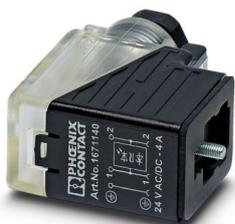
Connettore per valvole, Universale, 3-poli, Connettore per valvole BI (11 mm), Connessione a vite, connessione a vite per cavo Pg9, diametro esterno conduttore 6 mm ... 8 mm
