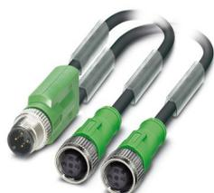
Cavo sensore/attuatore, 3-poli, PUR senza alogenati, grigio-nero RAL 7021, Maschio diritto M12, codifica: A, su Connettore femmina diritto M12, codifica: A, PIN 2+4 ponticellati e Connettore femmina diritto M12, codifica: A, PIN 2+4 ponticellati, lunghezza cavo: 1,5 m
