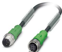
Cavo sensore/attuatore, 3-poli, PUR senza alogenati, grigio-nero RAL 7021, Maschio diritto M12, codifica: A, su Connettore femmina diritto M12, codifica: A, PIN 2+4 ponticellati, lunghezza cavo: 0,6 m
