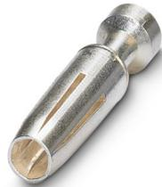
Contatto a crimpare, diametro contatti: 2,5 mm, tornito, Femmina, materiale contatti: Lega di rame, superficie contatti: argentato, sezione di connessione: 3 mm<sup>2</sup> ... 3 mm<sup>2</sup>, AWG 12
