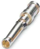
Contatto a crimpare, diametro contatti: 1,6 mm, tornito, Femmina, materiale contatti: Lega di rame, superficie contatti: argentato, sezione di connessione: 1,5 mm<sup>2</sup> ... 1,5 mm<sup>2</sup>, AWG 16
