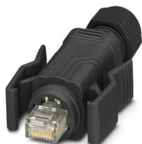
Connettore RJ45, tipo: RJ45, grado di protezione: IP67, numero poli: 8, 1 Gbit/s, CAT5, materiale: Plastica, tipo di connessione: Connessione rapida IDC, sezione di connessione: AWG 26- 23, uscita cavo: diritto, colore: nero intenso RAL 9005, Ethernet
