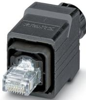
Connettore RJ45, grado di protezione: IP65/IP67, numero poli: 8, 1 Gbit/s, CAT5 (IEC 11801:2002), materiale: Plastica, tipo di connessione: Connessione rapida IDC, sezione di connessione: AWG 26- 22, uscita cavo: diritto, colore: nero, Ethernet
