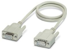
Cavo D-SUB confezionato schermato, 9 poli, flessibile (7 fili), colore cavo RAL 7000 (grigio), fissaggio mediante filettatura 4-40 UNC, grado di protezione IP20, testa 1 con femmina linguetta 1 e uscita cavo diritta, testa 2 con maschio linguetta 1 e uscita cavo diritta, lunghezza: 2 m
