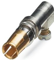
Contatto POWER, per inserti combinati D-SUB, connessione a vite, connettore femmina, diritto, corrente nominale 20 A, placcato oro
