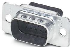
Inserto portacontatti D-SUB, grandezza linguetta 1, per 15 contatti di segnale, tipo contatto maschio, per contatti a crimpare, diritto, fissaggio mediante foro 3 mm, per telai da incasso e mobili VS-09-...
