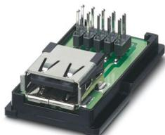
Inserto portacontatti femmina USB, 4 poli, femmina USB tipo A su connessione connettore flat cable, passo 2,54, per il sistema Freenet in telai da incasso, terminaloutlet IP20, Patchpanel 19" e Service-Interface
