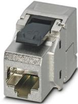
Insetto portacontatti femmina RJ45, modulare (Keystone), CAT6, 8 poli, schermato, con connessione cavo (LSA), per cavetti e conduttori rigidi AWG 26 ... 22
