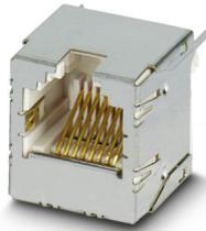
Connettoei per circuiti stampati RJ45, tipo: RJ45, grado di protezione: IP20, numero poli: 8, materiale: Metallo, tipo di connessione: THT a onde, uscita cavo: diritto
