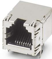
Connettoei per circuiti stampati RJ45, tipo: RJ45, grado di protezione: IP20, numero poli: 8, 1 Gbit/s, CAT5 (IEC 11801:2002), materiale: Metallo, tipo di connessione: THT a onde, uscita cavo: diritto
