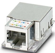
Inserto connettori femmina RJ45, tipo: RJ45, grado di protezione: IP20, numero poli: 8, CAT5, materiale: Metallo, tipo di connessione: Connessione IDC, sezione di connessione: AWG 24- 22, Ethernet
