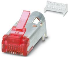
Inserto maschio RJ45, CAT6, 8 poli, schermato, connessione a perforazione di isolante IDC, per cavetti AWG 25... 24 e fili rigidi AWG 24, con fermacavi
