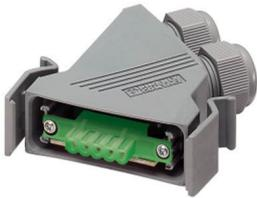
Connettore D-SUB, grado di protezione: IP67, numero poli: 5, materiale: Plastica, tipo di connessione: Connessione a vite, sezione di connessione: AWG 24- 12, uscita cavo: angolato, DeviceNet™
