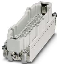
Inserto contatti, numero poli: 24+PE, dimensioni: B24, numero di connessioni per polo: 1, Spina, Connessione a crimpare, 500 V, 16 A, 0,5 mm<sup>2</sup> ... 4 mm<sup>2</sup>, applicazione: Potenza
