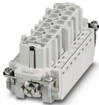
Inserto contatti, numero poli: 16+PE, dimensioni: B16, numero di connessioni per polo: 1, Femmina, Connessione a crimpare, 500 V, 16 A, 0,5 mm<sup>2</sup> ... 4 mm<sup>2</sup>, applicazione: Potenza
