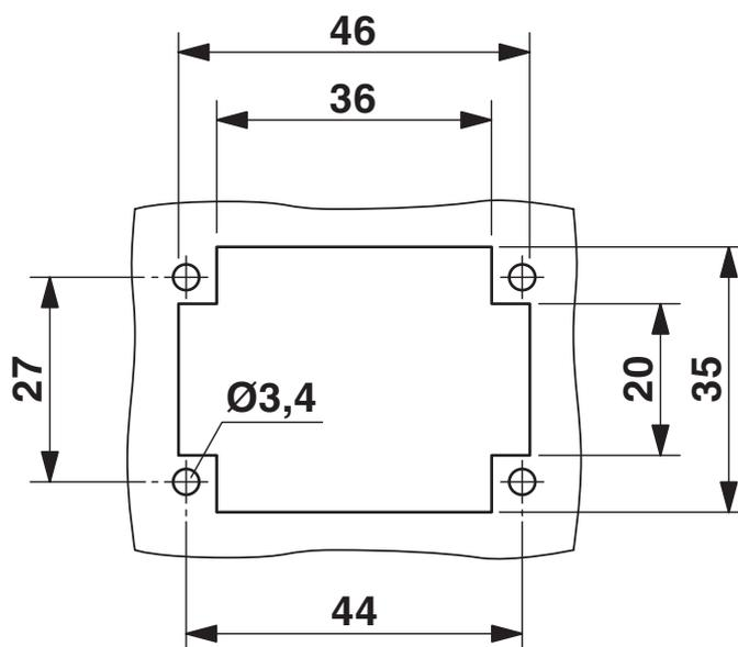
Sezione di montaggio nell'impiego senza custodia
