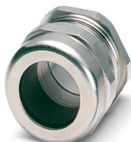
Attacchi a vite in metallo fino a 5 bar, lunghezza filettatura: 7 mm, diametro cavo : 14 - 21 mm, SW 34, attacco a vite: M25
