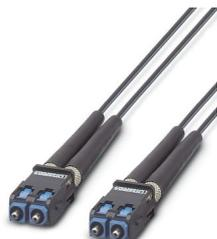
Cavo in fibra ottica confezionato, cavo breakout, fibra polimerica 980/1000 µm, SC-RJ/IP20 su SC-RJ/IP20, per la posa all'interno di quadri elettrici, cavo adatto all'impiego esterno con protezione UV, lunghezza: 2 m
