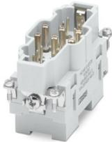
Inserto contatti, numero poli: 6+12+PE, dimensioni: B16, contatti di potenza: 6, contatti di comando: 12, Spina, Connessione a vite assiale, 690 V, 40 A, 2,5 mm<sup>2</sup> ... 10 mm<sup>2</sup>, applicazione: Potenza/segnale
