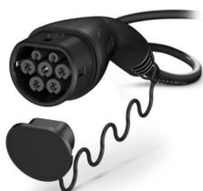
CHARX connect eco, Tipo 2, Cavo di ricarica AC, 32 A permanente, 480 V AC, con connettore di ricarica lato veicolo ed estremità aperta, cavi: 6,5 m, nero, dritto, con cappuccio di protezione, Logo PHOENIX CONTACT, IEC 62196-2, per la ricarica con corrente alternata (AC) di veicoli elettrici (EV)
