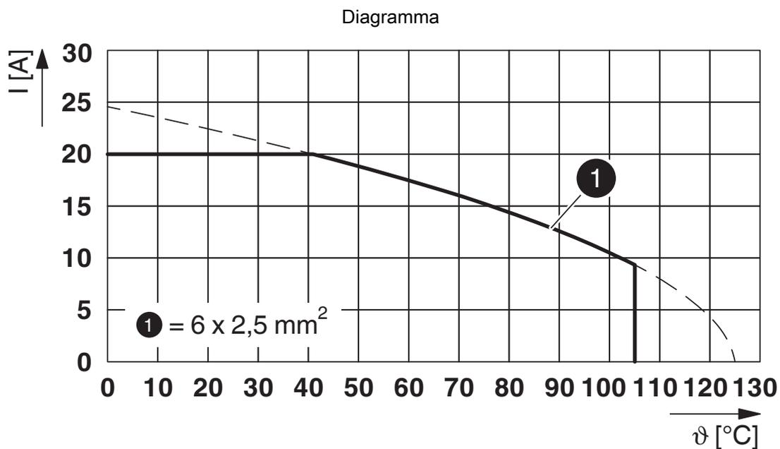
$I$  = intensità di corrente,  $\vartheta$  = temperatura ambiente, 6x 20 A
