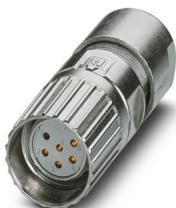
M23, Connnettore per cavi, serie: M23 PRO, diritto, schermati: sì, Bloccaggio a vite, Numero di poli: 6, Senso di rotazione: standard, tipo di connessione del contatto: Femmina, Connessione a crimpare, diametro cavi: 3 mm ... 15 mm, codifica: N, L'articolo è senza piombo secondo la direttiva RoHS II senza eccezione 6c (Pb < 0,1 %)
