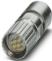
M23, Connettore per cavi, serie: M23 PRO, diritto, schermati: sì, Bloccaggio a vite, Numero di poli: 7, Senso di rotazione: standard, tipo di connessione del contatto: Spina, Connessione a crimpare, diametro cavi: 3 mm ... 15 mm, codifica: N, L'articolo è senza piombo secondo la direttiva RoHS II senza eccezione 6c (Pb < 0,1 %)
