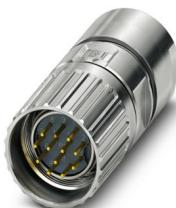
M23, Connnettore per cavi, serie: M23 PRO, diritto, schermati: sì, Bloccaggio a vite, Numero di poli: 12, Senso di rotazione: standard, tipo di connessione del contatto: Spina, Connessione a crimpare, diametro cavi: 6 mm ... 10 mm, codifica: N, L'articolo è senza piombo secondo la direttiva RoHS II senza eccezione 6c (Pb < 0,1 %)
