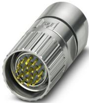
M23, Connettore per cavi, serie: M23 PRO, diritto, schermati: sì, Bloccaggio a vite, Numero di poli: 16+2+PE, Senso di rotazione: standard, tipo di connessione del contatto: Spina, Connessione a crimpare, diametro cavi: 6 mm ... 10 mm, codifica: N, L'articolo è senza piombo secondo la direttiva RoHS II senza eccezione 6c (Pb < 0,1 %)
