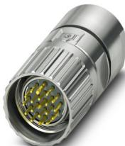
M23, Connnettore per cavi, serie: M23 PRO, diritto, schermati: sì, Bloccaggio a vite, Numero di poli: 16+2+PE, Senso di rotazione: standard, tipo di connessione del contatto: Spina, Connessione a crimpare, diametro cavi: 9 mm ... 15 mm, codifica: N, L'articolo è senza piombo secondo la direttiva RoHS II senza eccezione 6c (Pb < 0,1 %)
