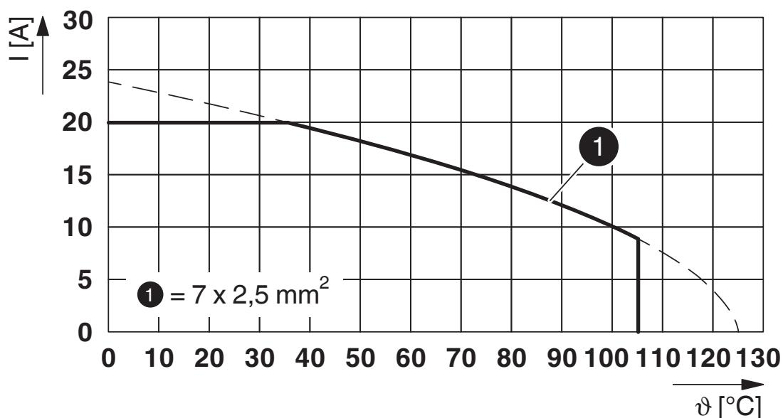
$I$  = intensità di corrente,  $\vartheta$  = temperatura ambiente,  $7 \times 20$  A
