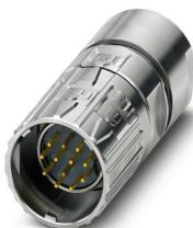
M23, Connnettore per cavi, serie: M23 PRO, diritto, schermati: sì, Bloccaggio rapido ONECLICK, Numero di poli: 12, Senso di rotazione: standard, tipo di connessione del contatto: Spina, Connessione a crimpere, diametro cavi: 9 mm ... 15 mm, codifica: N, L'articolo è senza piombo secondo la direttiva RoHS II senza eccezione 6c (Pb < 0,1 %)
