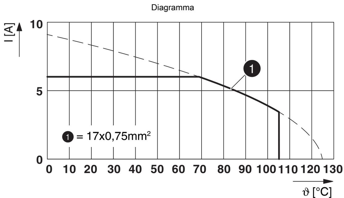
$I$  = intensità di corrente,  $\vartheta$  = temperatura ambiente, 17x 6 A
