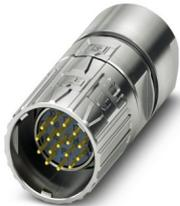
M23, Connettore per cavi, serie: M23 PRO, diritto, schermati: sì, Bloccaggio rapido ONECLICK, Numero di poli: 17, Senso di rotazione: standard, tipo di connessione del contatto: Spina, Connessione a crimpare, diametro cavi: 4 mm ... 8,5 mm, codifica: N, L'articolo è senza piombo secondo la direttiva RoHS II senza eccezione 6c (Pb < 0,1 %)
