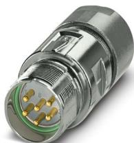
M23, Connnettore per giunti, serie: M23 PRO, diritto, schermati: sì, Per il bloccaggio rapido standard e ONECLICK, Numero di poli: 6, Senso di rotazione: standard, tipo di connessione del contatto: Spina, Connessione a crimpare, diametro cavi: 9 mm ... 15 mm, codifica: N, L'articolo è senza piombo secondo la direttiva RoHS II senza eccezione 6c (Pb < 0,1 %)
