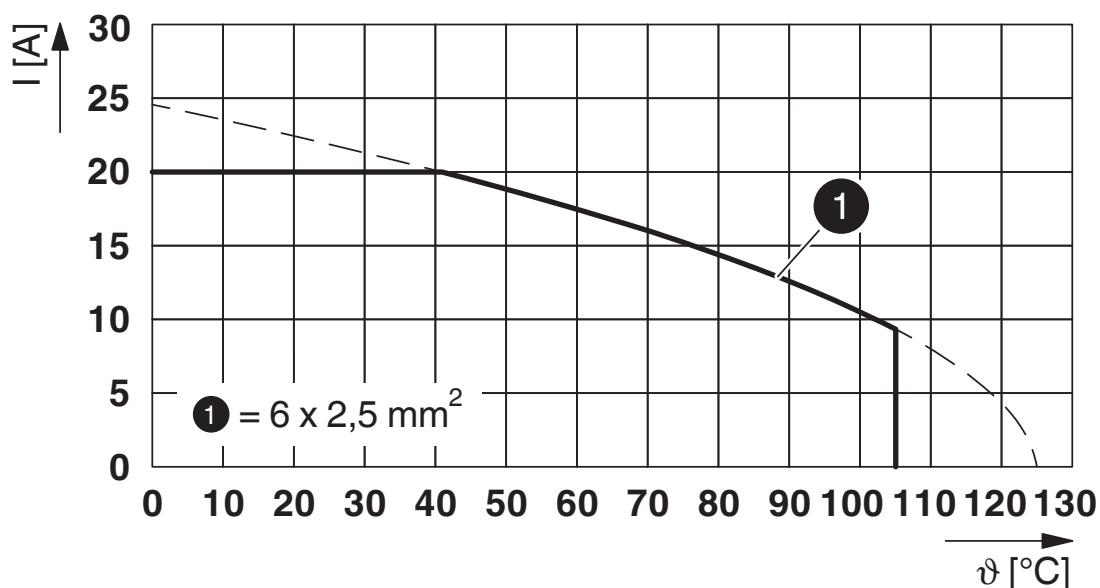
$I$  = intensità di corrente,  $\vartheta$  = temperatura ambiente,  $6 \times 20 \text{ A}$
