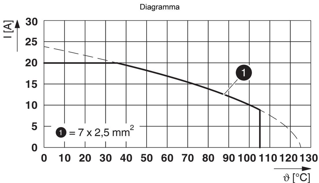
$I$  = intensità di corrente,  $\vartheta$  = temperatura ambiente, 7x 20 A
