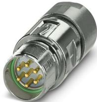
M23, Connettore per giunti, serie: M23 PRO, diritto, schermati: sì, Per il bloccaggio rapido standard e ONECLICK, Numero di poli: 7, Senso di rotazione: standard, tipo di connessione del contatto: Spina, Connessione a crimpare, diametro cavi: 6 mm ... 10 mm, codifica: N, L'articolo è senza piombo secondo la direttiva RoHS II senza eccezione 6c (Pb < 0,1 %)
