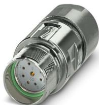
M23, Connnettore per giunti, serie: M23 PRO, diritto, schermati: sì, Per il bloccaggio rapido standard e ONECLICK, Numero di poli: 8+1, Senso di rotazione: standard, tipo di connessione del contatto: Femmina, Connessione a crimpare, diametro cavi: 6 mm ... 10 mm, codifica: N, L'articolo è senza piombo secondo la direttiva RoHS II senza eccezione 6c (Pb < 0,1 %)
