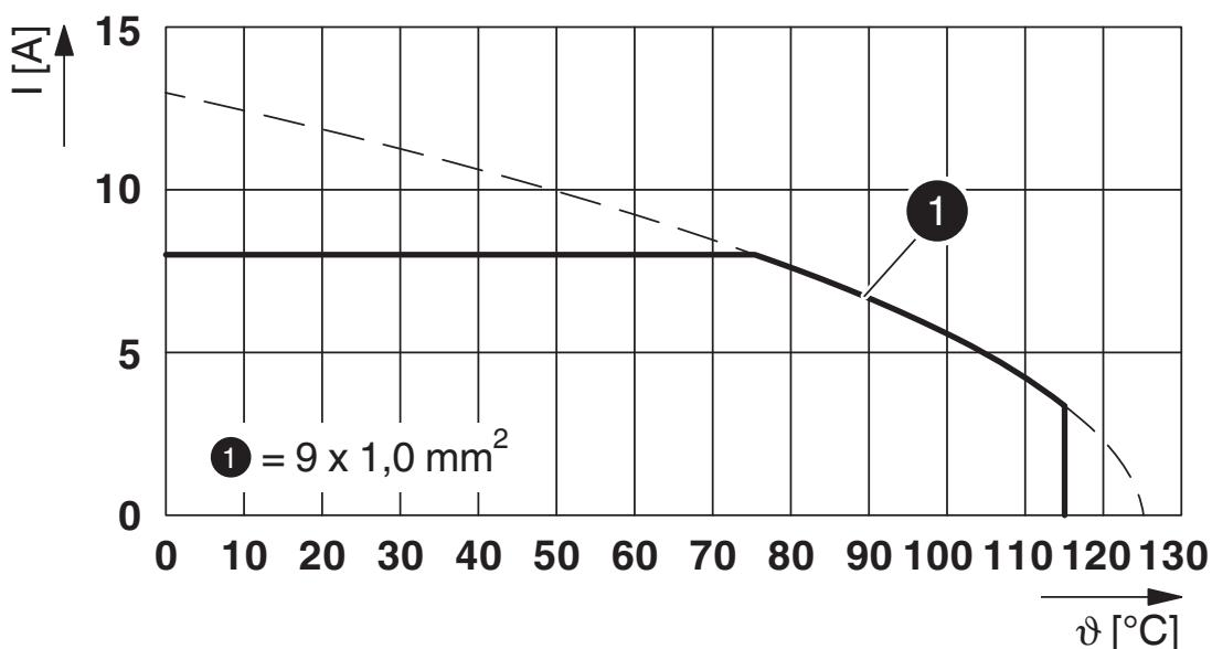
$I$  = intensità di corrente,  $\vartheta$  = temperatura ambiente, 9x 8 A
