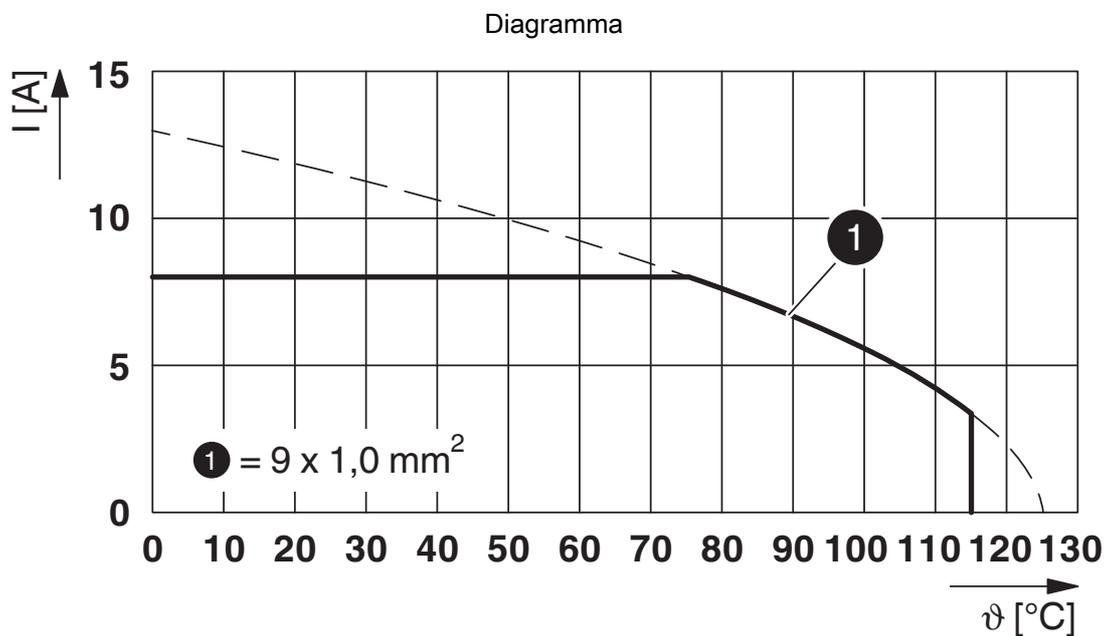
$I$  = intensità di corrente,  $\vartheta$  = temperatura ambiente, 9x 8 A
