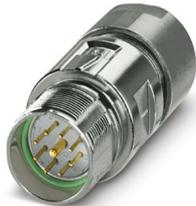
M23, Connettore per giunti, serie: M23 PRO, diritto, schermati: sì, Per il bloccaggio rapido standard e ONECLICK, Numero di poli: 8+1, Senso di rotazione: standard, tipo di connessione del contatto: Spina, Connessione a crimpare, diametro cavi: 4 mm ... 8,5 mm, codifica: N, L'articolo è senza piombo secondo la direttiva RoHS II senza eccezione 6c (Pb < 0,1 %)
