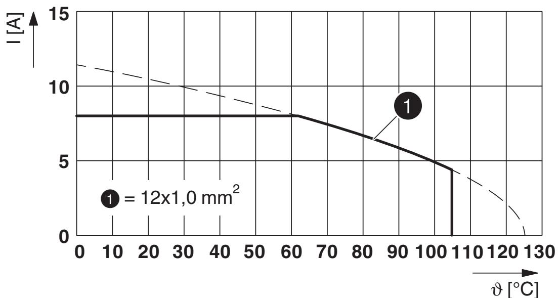
I = intensità di corrente, θ = temperatura ambiente,  $12 \times 8 \text{ A}$
