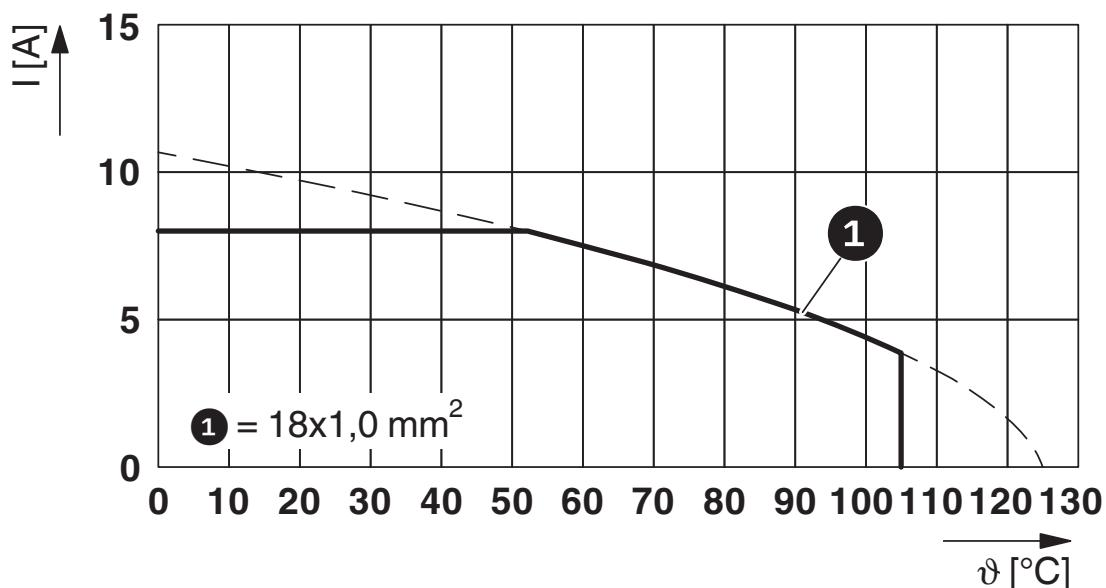
$I$  = intensità di corrente,  $\vartheta$  = temperatura ambiente, 18x 8 A
