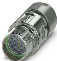
M23, Connnettore per giunti, serie: M23 PRO, diritto, schermati: sì, Per il bloccaggio rapido standard e ONECLICK, Numero di poli: 16+2+PE, Senso di rotazione: standard, tipo di connessione del contatto: Femmina, Connessione a crimpere, diametro cavi: 6 mm ... 10 mm, codifica: N, L'articolo è senza piombo secondo la direttiva RoHS II senza eccezione 6c (Pb < 0,1 %)
