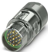
M23, Connettore per giunti, serie: M23 PRO, diritto, schermati: sì, Per il bloccaggio rapido standard e ONECLICK, Numero di poli: 16+2+PE, Senso di rotazione: standard, tipo di connessione del contatto: Spina, Connessione a crimpare, diametro cavi: 6 mm ... 10 mm, codifica: N, L'articolo è senza piombo secondo la direttiva RoHS II senza eccezione 6c (Pb < 0,1 %)
