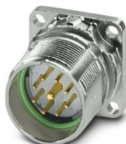
M23, Connettore per apparecchi anteriore, serie: M23 PRO Signal, diritto, schermati: sì, Per il bloccaggio rapido standard e ONECLICK, Numero di poli: 8+1, Senso di rotazione: standard, tipo di connessione del contatto: Spina, Connessione a crimpare, 4x Ø 3,2, misura flangia: 26 mm x 26 mm, codifica: N, L'articolo è senza piombo secondo la direttiva RoHS II senza eccezione 6c (Pb < 0,1 %)
