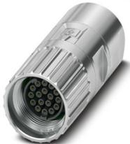
M17, Connettore per cavi, serie: M17 PRO, diritto, schermati: sì, Bloccaggio a vite, Numero di poli: 17, Senso di rotazione: standard, tipo di connessione del contatto: Femmina, Connessione a crimpare, diametro cavi: 5,5 mm ... 9,5 mm, codifica: N, L'articolo è senza piombo secondo la direttiva RoHS II senza eccezione 6c (Pb < 0,1 %)
