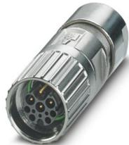
M17, Connettore per cavi, serie: M17 PRO, diritto, schermati: sì, Bloccaggio a vite, Numero di poli: 5+3+PE, Senso di rotazione: standard, tipo di connessione del contatto: Spina, Connessione a crimpare, diametro cavi: 3,5 mm ... 6,5 mm, codifica: N, L'articolo è senza piombo secondo la direttiva RoHS II senza eccezione 6c (Pb < 0,1 %)
