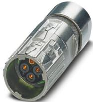
M17, Connettore per cavi, serie: M17 PRO, diritto, schermati: sì, Bloccaggio rapido ONECLICK, Numero di poli: 3+PE, Senso di rotazione: standard, tipo di connessione del contatto: Femmina, Connessione a crimpare, diametro cavi: 5,5 mm ... 9,5 mm, codifica: N, L'articolo è senza piombo secondo la direttiva RoHS II senza eccezione 6c (Pb < 0,1 %)
