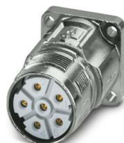
M23, Connettore per apparecchi anteriore, serie: M23 PRO, diritto, schermati: sì, Per il bloccaggio rapido standard e ONECLICK, Numero di poli: 5+PE, Senso di rotazione: standard, tipo di connessione del contatto: Femmina, Connessione a crimpare, 4x Ø 3,2, misura flangia: 26 mm x 26 mm, codifica: N, L'articolo è senza piombo secondo la direttiva RoHS II senza eccezione 6c (Pb < 0,1 %)
