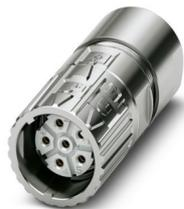
M23, Connettore per cavi, serie: M23 PRO, diritto, corto, schermati: sì, Bloccaggio rapido ONECLICK, Numero di poli: 5+PE, Senso di rotazione: standard, tipo di connessione del contatto: Femmina, Connessione a crimpare, diametro cavi: 5,5 mm ... 15 mm, codifica: N, L'articolo è senza piombo secondo la direttiva RoHS II senza eccezione 6c (Pb < 0,1 %)
