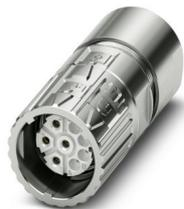
M23, Connettore per cavi, serie: M23 PRO, diritto, corto, schermati: sì, Bloccaggio rapido ONECLICK, Numero di poli: 4+3+PE, Senso di rotazione: standard, tipo di connessione del contatto: Femmina, Connessione a crimpare, diametro cavi: 5,5 mm ... 15 mm, codifica: N, L'articolo è senza piombo secondo la direttiva RoHS II senza eccezione 6c (Pb < 0,1 %)
